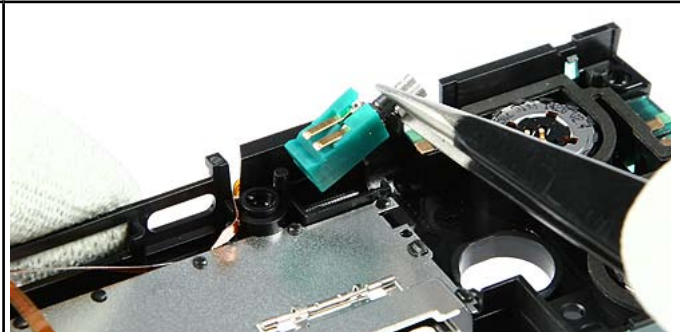
30. Lever out the Vibra.
